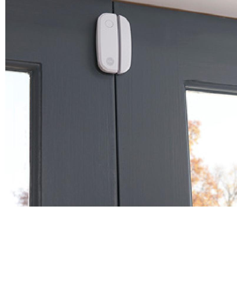
Yale Sync magnetni kontakt za vrata / prozor osigurava glavne pristupne točke u kući i oko nje. Kad je alarm uključen te se vrata ili prozor otvaraju, kontakt i magnet gube vezu, što aktivira alarm.
